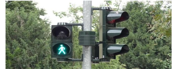
**Bild:** Ampel mit Blindenton
