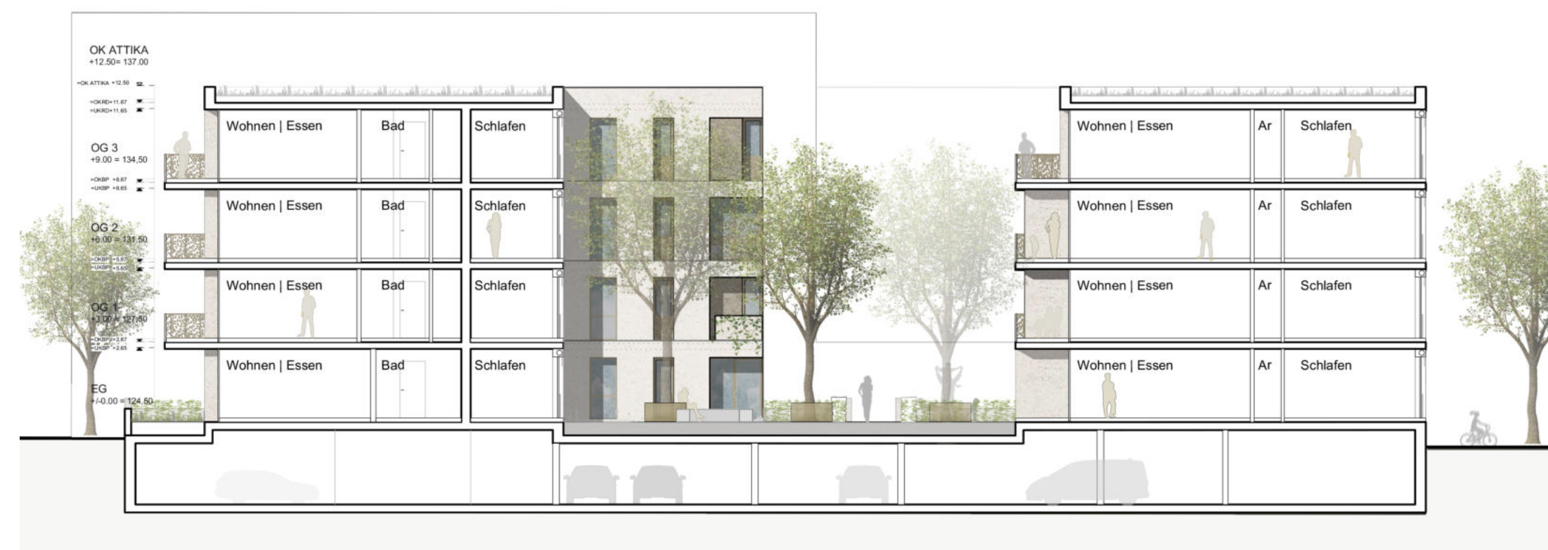
Schnitt - Ansicht Gebäude 1 u 2 M 1.200
