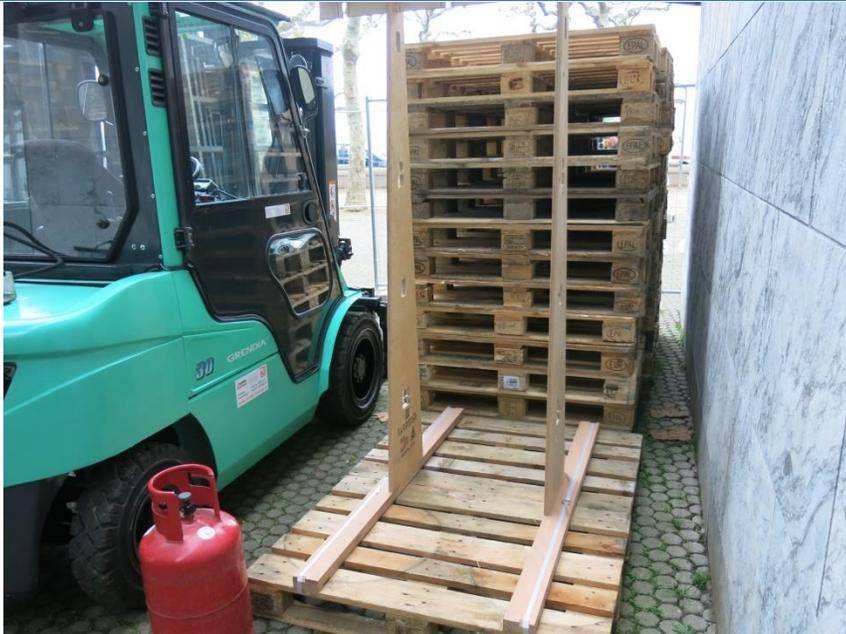
Abb.17: Glasböcke auf Palette als Stellage für Gitterelemente
