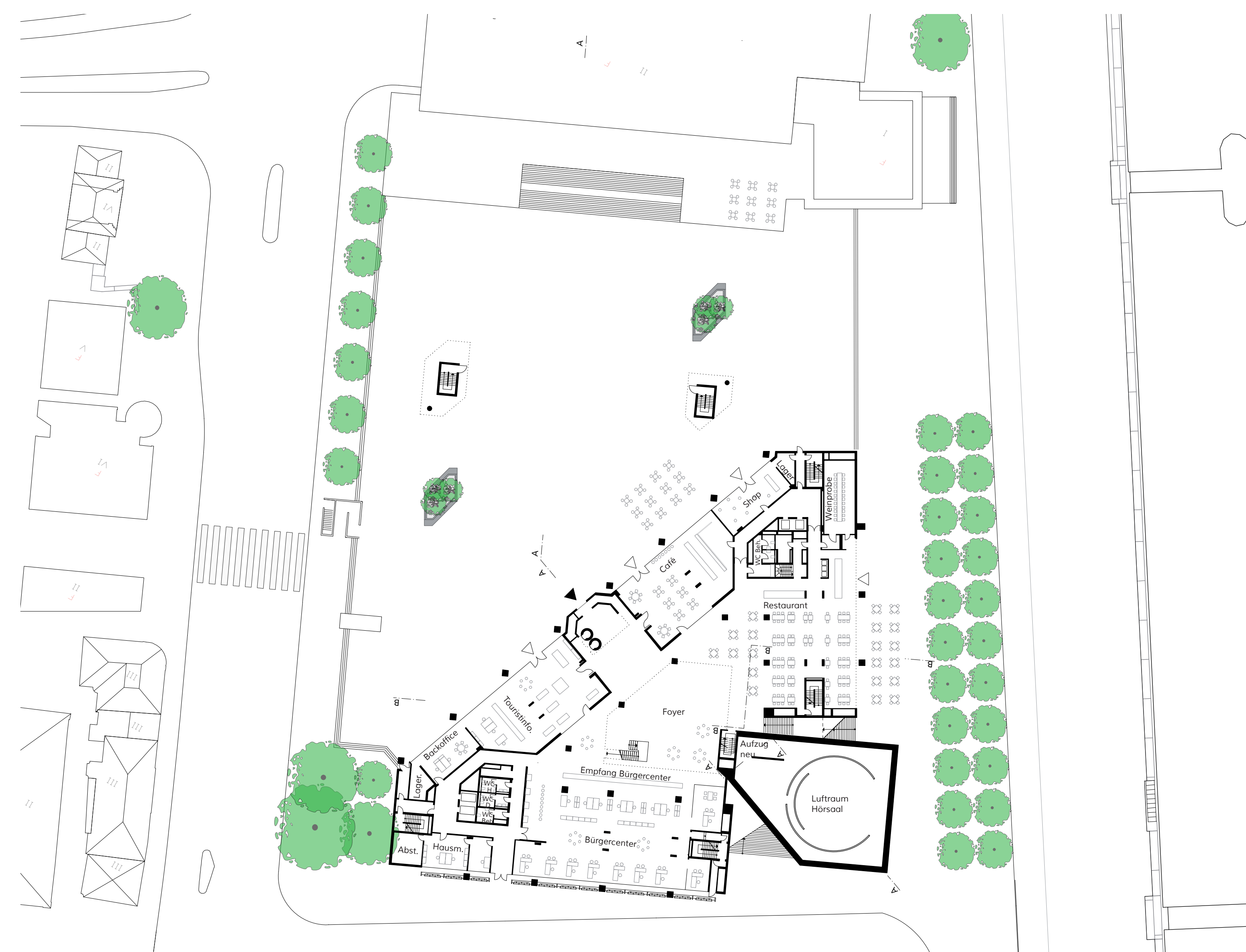
Grundriss 1.UG (neue Eingangsebene) M. 1:500
