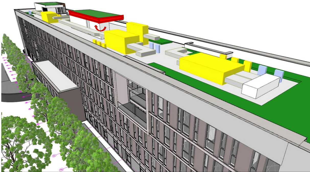
Abbildung 27: In der Schrägaufsicht auf die Dachaufbauten sind geeignete Bereiche (rote Kontur) markiert, in denen Nischenbrüter und Fledermauskästen eine hohe Erfolgchance (Eintrittswahrscheinlichkeit) auf Besiedlung haben. Wichtig ist hier keine nächtliche Störung (Fledermäuse) und die Orientierung an Gebäudekanten.
