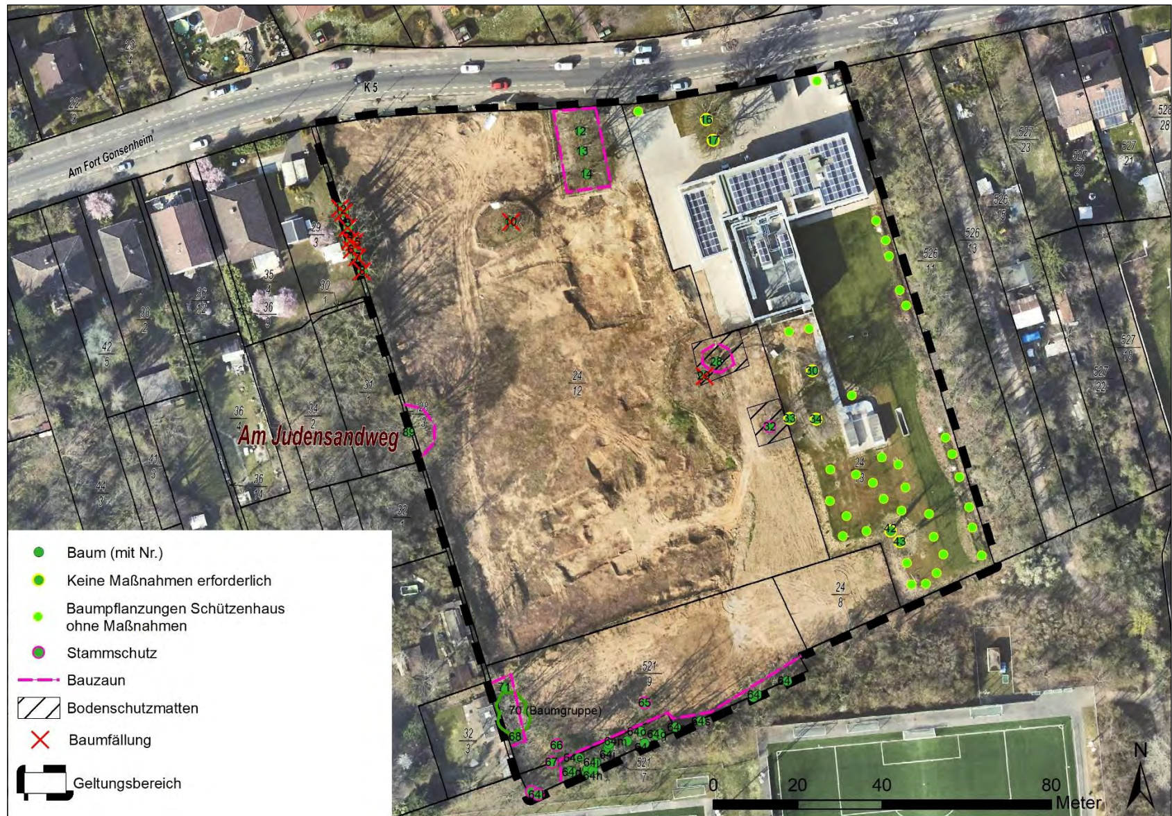
Abbildung 15: Baumfällungen und Baumschutz während der Bauphase (Quelle Luftbild: Stadt Mainz, 2022)
