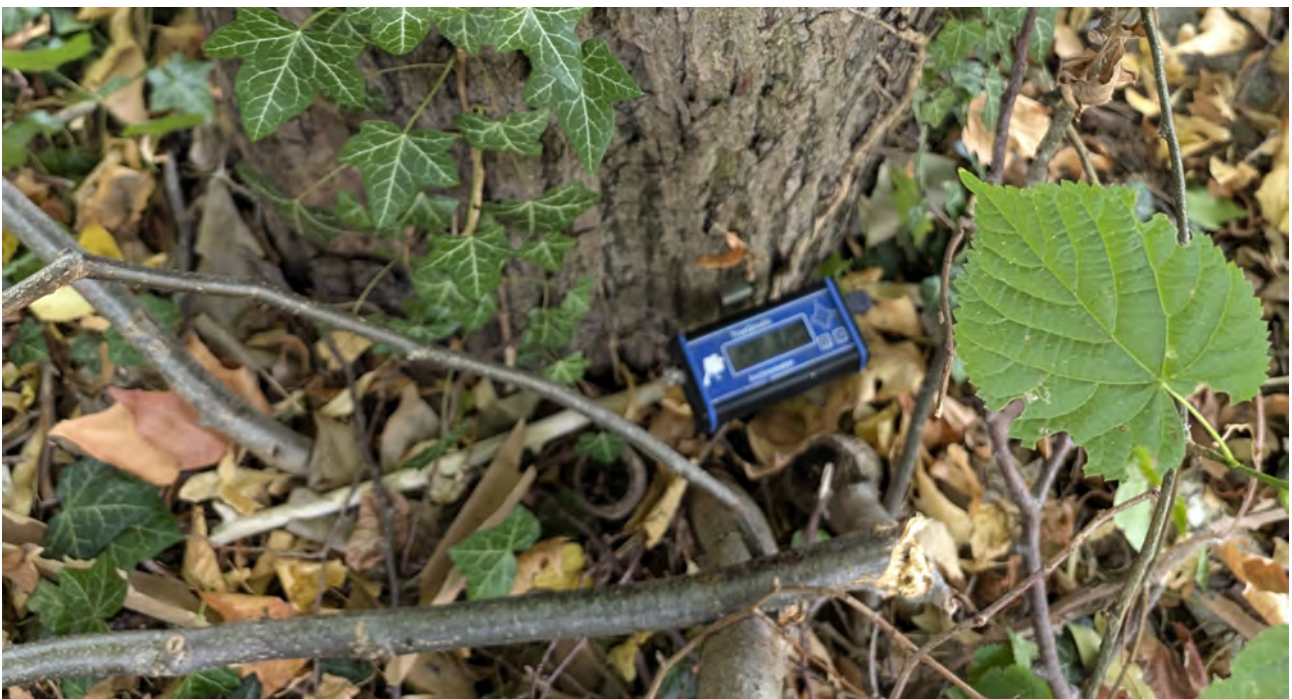
Abbildung 15: Inclinometer (Neigungssensor) am Stammfuß, 180° zur Zugrichtung.
