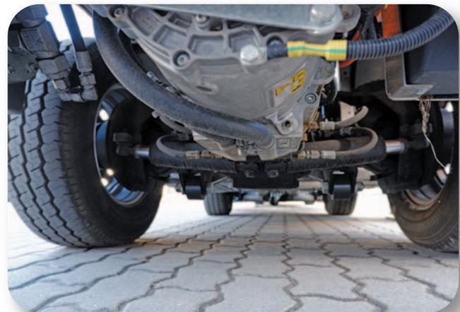
Leise Technik: Elektromotoren an Kehrmaschinen
