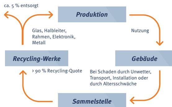
Der Recyclingkreislauf einer Solaranlage
